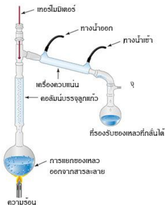
ภาพที่ 7 ชุดอุปกรณ์ในการกลั่นลำดับส่วน
