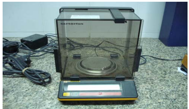
เครื่องชั่งอย่างละเอียดใช้ชั่งสารเคมีที่ใช้ในปริมาณน้อย มีความแม่นยำอยู่ที่ทศนิยม 4 แห่ง
