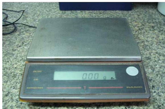
เครื่องชั่งหยาบใช้ชั่งสารเคมีที่มีความแม่นยำอยู่ที่ ทศนิยม 2 ตำแหน่ง
