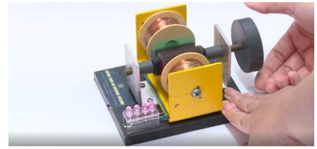
หลอดไฟฟ้าสว่างเมื่อหมุนแกนหมุนของชุดสาธิตเครื่องกำเนิดไฟฟ้า
